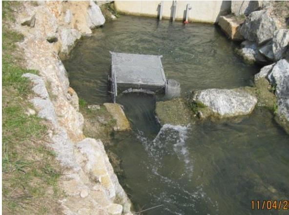
**Abb. 9:** Reuse im Beckenpass Atzenhofer
